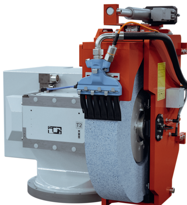
3 En detail: Der mit SmartJet ausgestattete Schleifkopf der S36. Noch im Jahr 2023 werden auch die Schleifköpfe der Maschinenversionen S31, S33 und S41 mit dem Kühlsystem ausgestattet
